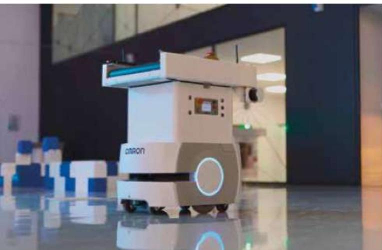
Il robot mobile Omron LD-60 permette la movimentazione dinamica di materiali in luoghi affollati e con passaggi ristretti.
