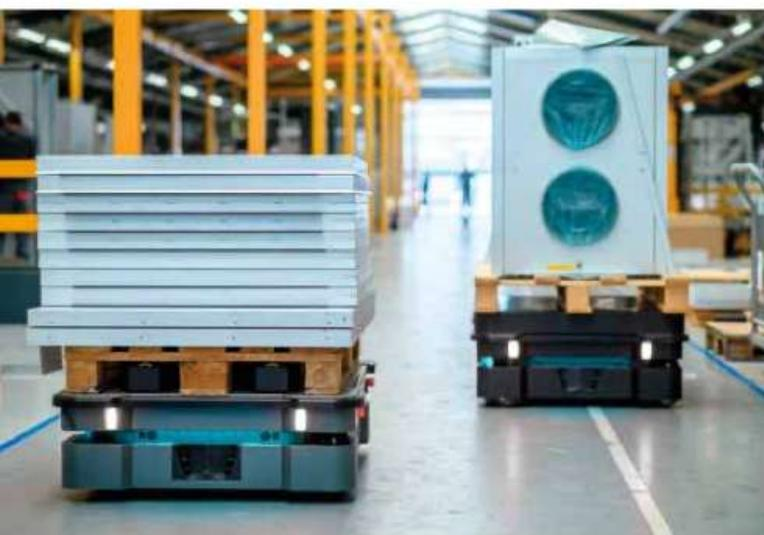
I robot mobili autonomi MiR distribuiti da Klain hanno laser scanner e telecamere 3D per scannerizzare l'ambiente circostante a 360°.
