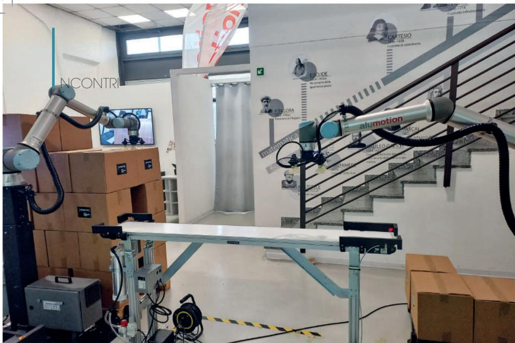
L'impanto di pallettizzazione plug&play Robotiq Palletizing Solution, con sistema di compensazione del peso di Cobot Lift.
