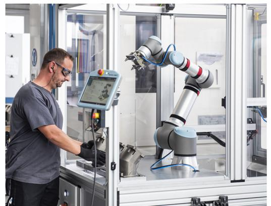
*UR16e, il nuovo braccio robotico collaborativo che offre una capacità di carico fino a 16 kg*
