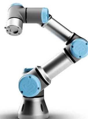
\*Il robot può operare ad un intervallo di temperatura di 0-50°C. In caso di velocità sostenuta e continua dei giunti, la temperatura ambiente è ridotta.
