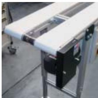
Due nastri trasportatori azionati da un motore con trazione di testa
