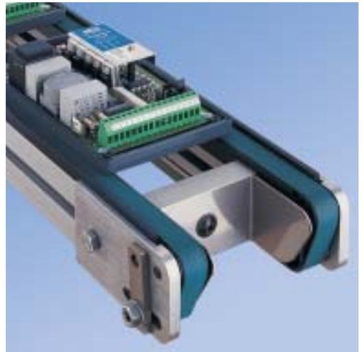
Standard DGF-P 2001 con pallet per l'inserimento di componenti in circuiti stampati
