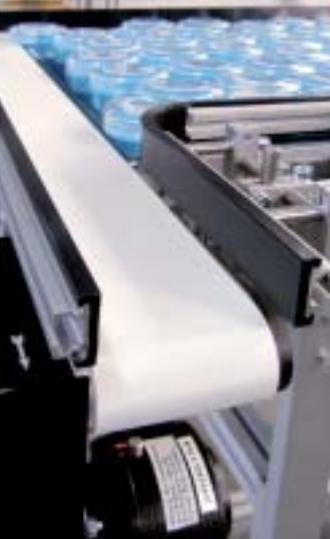
GUF-P 2000 come trasportatore trasversale e smistatore dopo una sezione di raffreddamento
