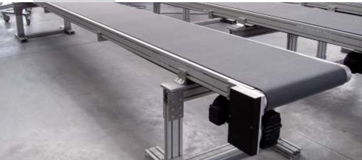
I dadi per l'installazione di guide laterali o piastre per sensori possono essere inseriti nelle scanalature a T a discrezione del cliente
