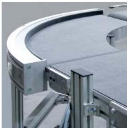
Il trasferimento tra KGF-P 2040 e GUF-P 2041 con barra di pressione rotante per prodotti con lunghezza da 50 mm
