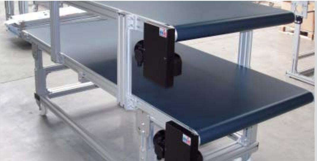
Due GUF-P 2041 in tandem con sistema mobile per l'alimentazione doppia di un macchinario
