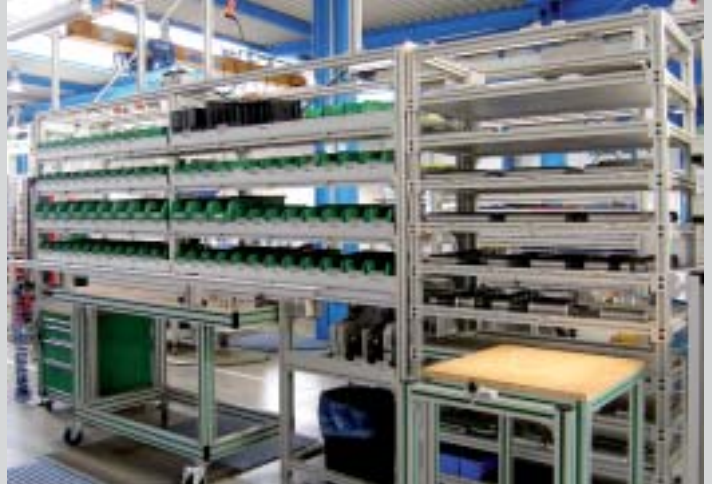
Le stazioni di lavoro Kanban aumentano la produttività di assemblaggio garantendo la logistica delle parti
