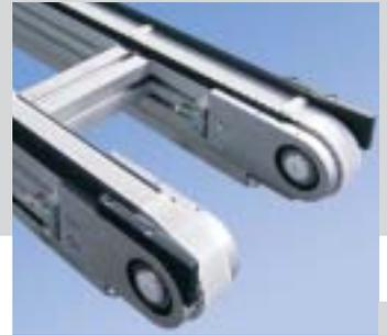
Il sistema trasportatore ZRF-P 2010 monta una cinghia dentata per il trasporto di pallet pesanti o di prodotti strutturalmente rigidi. Grazie all'inserimento positivo dei denti della cinghia e delle ruote, le cinghie sono sincronizzate e i trasportatori sono ideali per applicazioni con posizionamenti. Tra le funzioni più degne di nota di questo trasportatore vi sono profili di scorrimento plastici, che evitano il contatto tra
