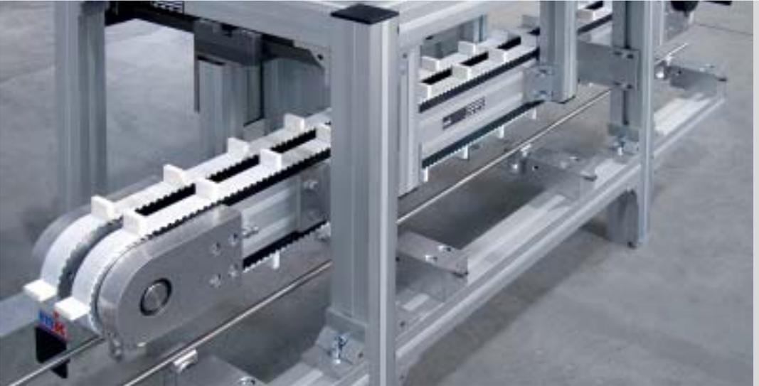
Nastro trasportatore dentata a due corsie con larghezza regolabile e profili
