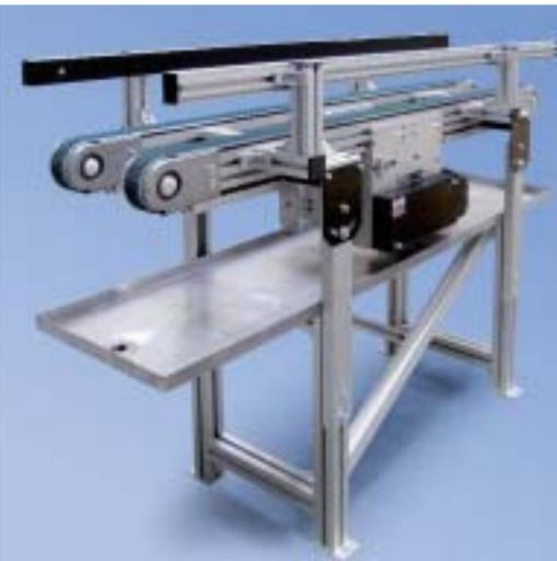
Nastro dentata con struttura telescopica e vaschetta
