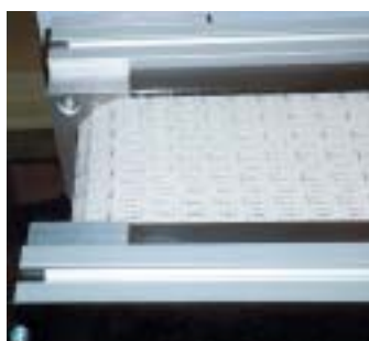
MBF-P 2040.02 con guida laterale speciale, nastro con 10% di area aperta
