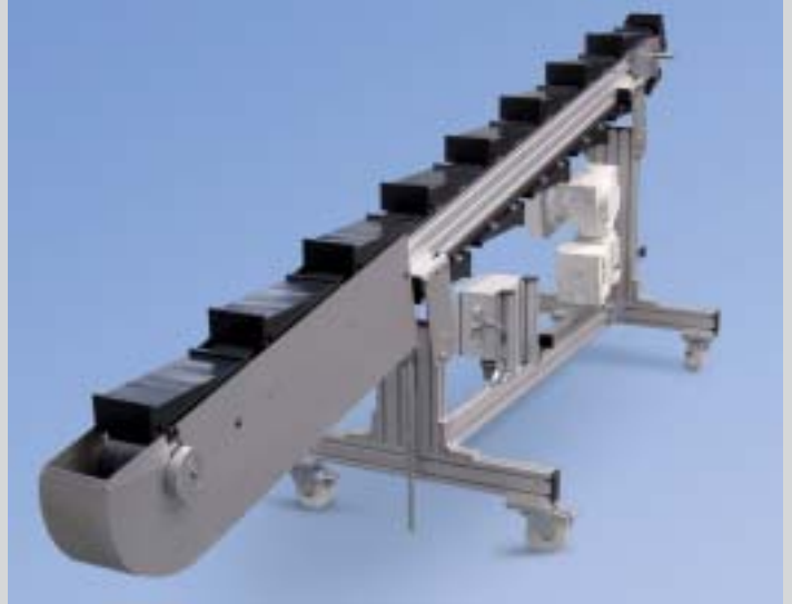
KTF-P 2040 con inclinazione e accessori speciali che consentono il posizionamento orizzontale del prodotto durante il trasporto inclinato
