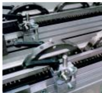
KTF-P 2010 con guide laterali regolabili e maniglie regolabili per larghezze del prodotto che cambiano di frequente
