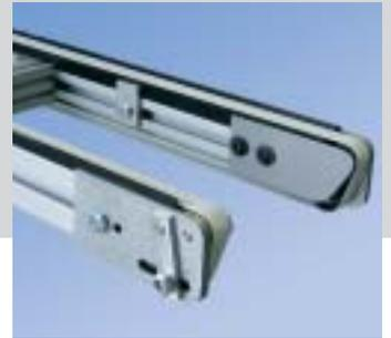
Sistema trasportatore DGF-P 2001 è progettato principalmente per il trasporto di pallet. È adatto alle linee di montaggio come quelle dell'industria elettronica, ad esempio. Il rullo della testata dal diametro ridotto consente il trasferi-
