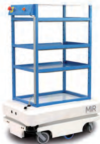
MiR100, MiR200 e MiR500 sono veicoli a guida autonoma (SGV) laser guidata (LGV)
