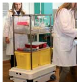
MiR100, MiR200 e MiR500 sono veicoli a guida autonoma (SGV) laser guidata (LGV)
