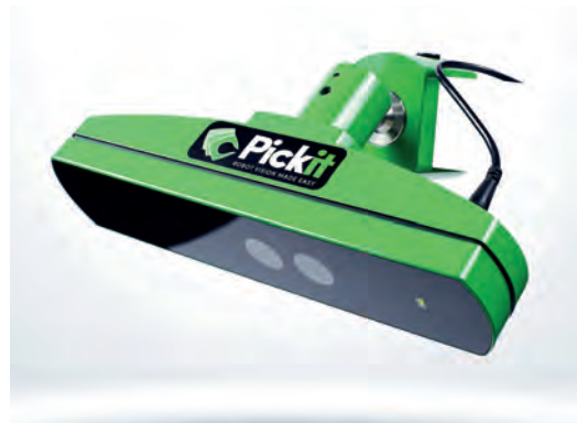
Pick-it è un prodotto plug and play, by Alumotion, che guida il robot nella scelta e posizionamento di una vasta gamma di oggetti, in diverse applicazioni.
