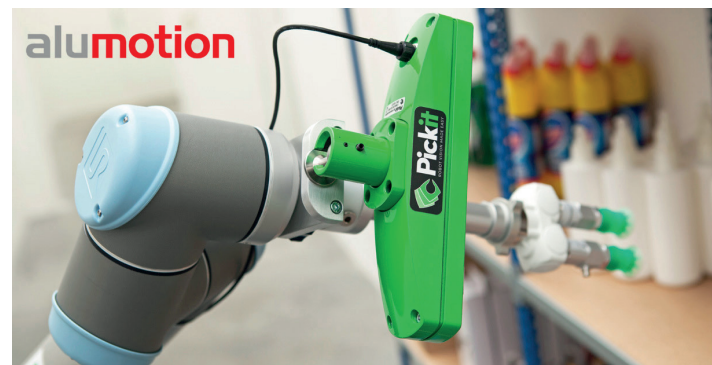
Pick-it: sistema di visione è dotato di una camera 3D pre-calibrata.
