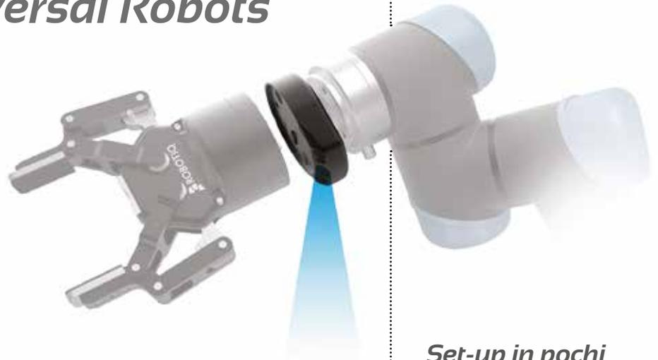
Wrist Camera è il sistema plug&play di visione 2D specifico per i robot Universal Robots.
