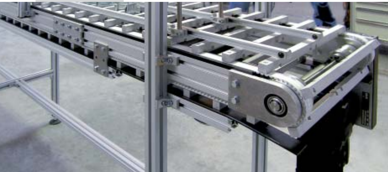
ZRF-P 2040.02 con boccole filettate inserite e installate all'interno del nastro dentata, portapezzi personalizzati
