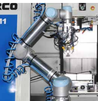
Il robot apre entrambe le porte, inserisce la materia grezza, serra la morsa della macchina, la ritoglie dopo la fresatura e la mette da parte.
