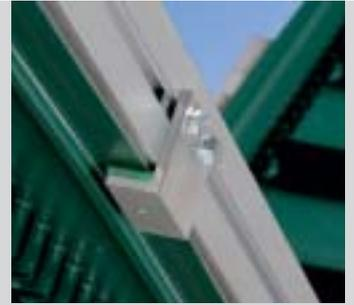
Grazie al suo design compatto basato sui Profili strutturali in alluminio mk 2000, il Sistema trasportatore KFG-P 200 è l'ideale per applicazioni a servizio continuo in ambienti con più turni. Utilizzato principalmente per il trasporto di piccoli elementi, il nastro nel piano inclinato è guidato da guide a V saldate. Come
